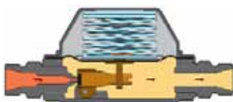
Abb. 13 · Allgemeiner Aufbau eines Druckminderers. (Quelle: GOK)
