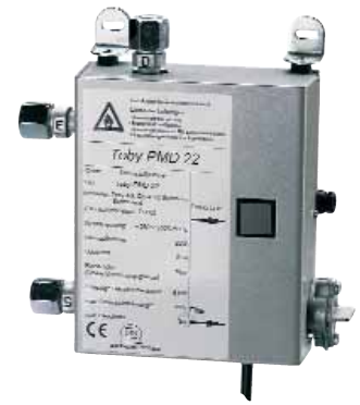
Abb. 7 · Schwingkolbenpumpe Typ Toby PMD 22 als Förderaggregat intermittierend, extern elektrisch gesteuert arbeitend für externe Verbrauchsstellen mit Flammenüberwachung. (Quelle: GOK)
